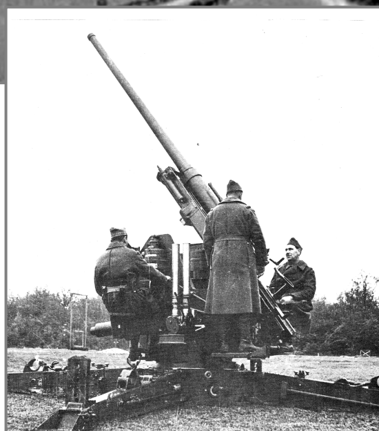
75 CA modèle 32 sur affût fixe à 4 flèches. Tube proche de son angle de tir maximum de 70° permettant un plafond de 7000m.
