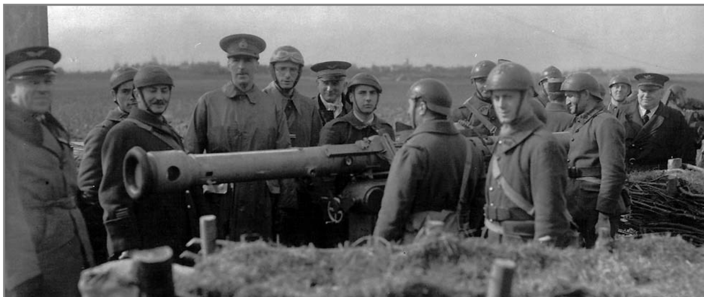
Télémètre permettant de mesurer la distance de l'avion par des moyens optiques Remarquer le casque DCA échancré autour de l'oreille
