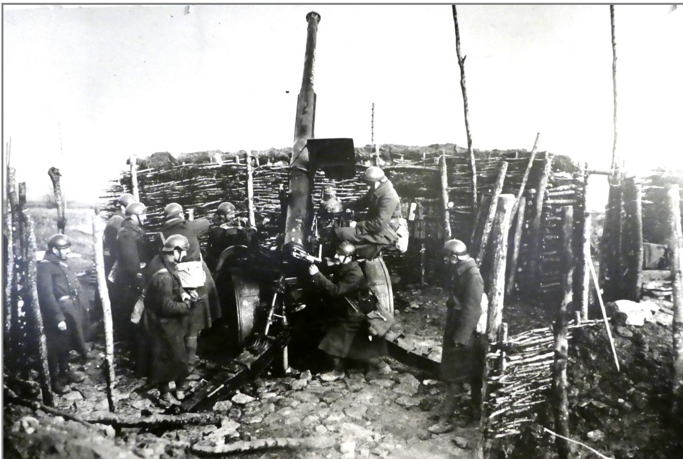
Canon de 75 mm 1917 modifié 1934 à 4 flèches, protégé par des fascines
